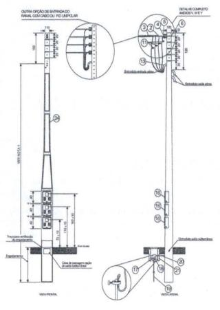
O kit postinho é uma atualização do padrão antigo. A caixa que abrigava o medidor e era fixada por suportes plásticos passou a ser embutida dentro do poste. Com isso, a fiação que era conduzida com eletrodutos pelo lado externo, agora é interna.
